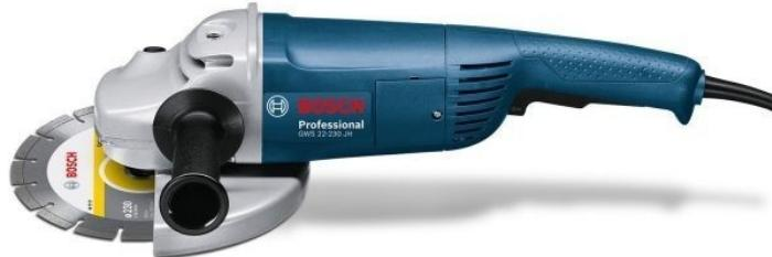
**Potenza assorbita nominale** 2200 W**Peso** 5,2 kg**Dimensioni** 200 x 590 x 135 mm**Numero di corse a vuoto** 6.500 min-1**Filettatura albero** M 14**Tipo di interruttore** Tri-Control**Diametro disco** 230 mm**Voltaggio (V)** 230 V
