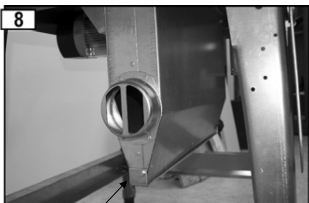
Spanenafvalsleuf gesloten (bedrijf met spanenafzuigvoorziening)
