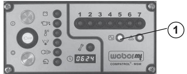
Während der Verdichtungsarbeit wird permanent die Verdichtung gemessen und optisch über die gelben (LED's) 1 - 7 (1) gezeigt. Die maximal mögliche Verdichtung ist erreicht, sobald kein weiterer Zuwachs der aufleuchtenden LED's mehr feststellbar ist.
