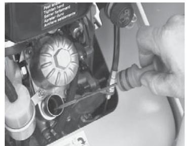
Korrekter Ölstand zwischen min. und max. Markierung.
