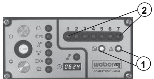
Bei Aufleuchten der roten und grünen LED (1) ist das Material nicht verdichtbar. Ein Bodenaustausch mit verdichtbarem Material ist vorzunehmen.
