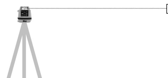
Pour atteindre la pente de 3%, la cellule doit être déplacée de 30cm et doit être fixée.
