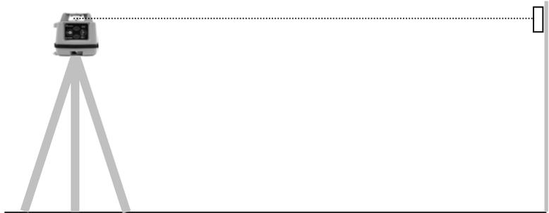
Beginnen Sie mit der Kalibrierung der X-Achse, d.h. der Empfänger muss zur X-Achse des Empfängers stehen (in Pfeilrichtung der Gehäusemarkierung X). Richten Sie die Achse des Gerätes über die Richtkerben am Gehäuseoberteil möglichst genau auf den Empfänger aus.
