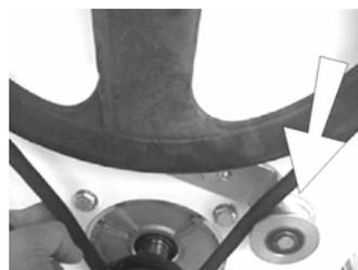
Die Schrauben des Keilriemenspanners unter Zuhilfenahme eines Schraubenschlüssels lösen. Anschließend den Keilriemenspanner gegen den Keilriemen schieben und erneut die Spannung kontrollieren. Schieben sie den Spanner so lange hin und her bis sie die gewünschte Spannung erreicht haben. Wenn sie die erforderliche Spannung eingestellt haben, ziehen sie die Befestigungsschrauben des Keilriemenspanners fest.
