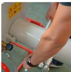
Anschließend die Mischkammer einführen und durch drehen (im Uhrzeigersinn) sauber verriegeln.
