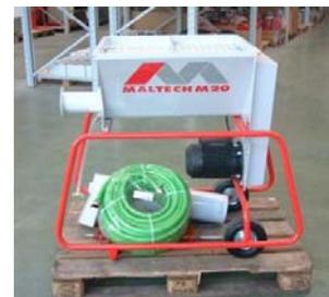
Für die Erstinbetriebnahmen müssen die getrennt mitgelieferte Mischkammer und Mischwelle aufgebaut werden. Hierfür ist die Maschine von der Transportpalette zu heben.
