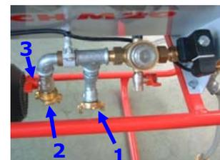
Wasserzufuhrschlauch an der Maschine (**1**) und an einen externen Wasserhahn anschließen und Luft aus dem Schlauch ablassen. Dazu muss der Ablasshahn (**3**) an der Maschine so lange geöffnet werden, bis keine Bläschen mehr austreten.
