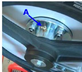
Zuerst muss die Sicherheitsabdeckung an der Rückseite der Maschine entfernt werden. Anschließend die Antriebswelle über den entsprechenden Schmiernippel (A) einfetten. Nach Beendigung des Schmiervorgangs muss die Abdeckung an der Maschine wieder ordnungsgemäß montiert werden.
