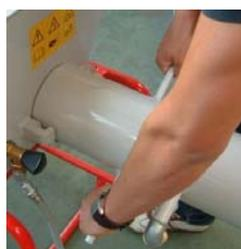
Anschließend die Mischkammer einführen und durch drehen (im Uhrzeigersinn) sauber verriegeln.
