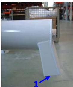
Anschließend ist die Konsistenz des Materials an der Materialaustrittsöffnung der Mischkammer (1) zu prüfen und eventuell die Wassermenge zu korrigieren.
