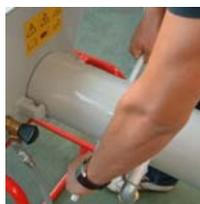
Anschließend kann durch drehen der beiden Verriegelungsgriffe (gegen Uhrzeiger) die Mischkammer abmontiert werden.
