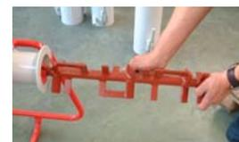
Reinigen Sie die Mischkammer und die Mischwelle am besten mit fließendem Wasser. Bei besonders hartnäckigen Verkrustungen kann eine Nichtmetall-Bürste verwendet werden. Dabei ist eine Beschädigung der Wände dieser beiden Teile auf jeden Fall zu vermeiden.
