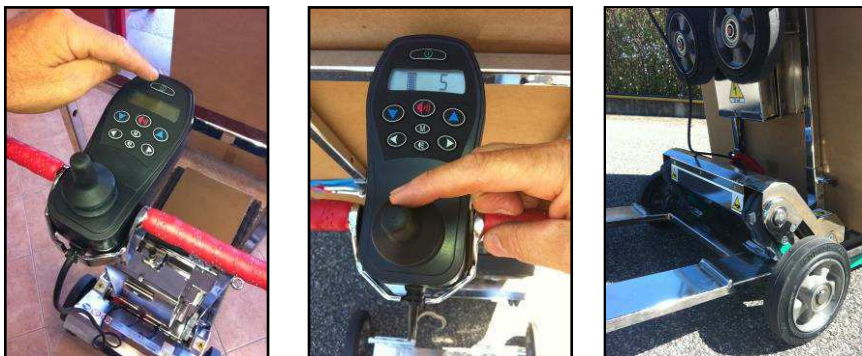
Figura 28 t Salita del carrello saliscale DOMINO sulla base carrellata.
