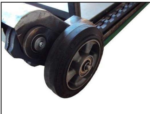
Figura 18 t Ruote per la traslazione correttamente montate sul carrello saliscale DOMINO.
