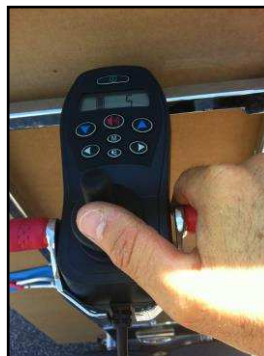
Figura 30 t Comando della traslazione in avanti del carrello per la discesa dalla base carrellata.
