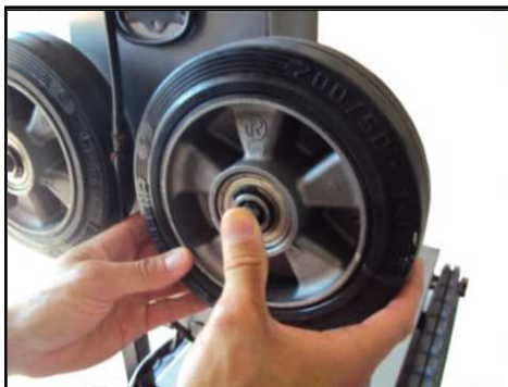
Figura 16 t Estrazione delle ruote dalla loro sede.
