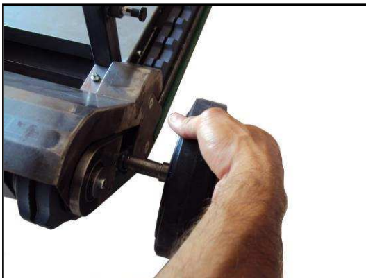
Figura 17 t Inserimento delle ruote di traslazione sul carrello saliscale DOMINO.
