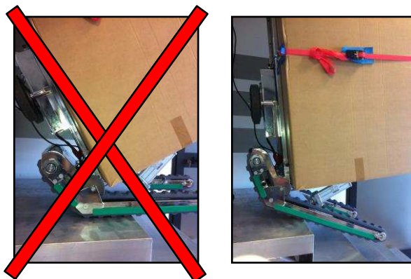
Figura 38 t Errata discesa dalla scalinata / Corretta discesa della scalinata.
