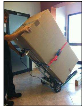
Figura 27 t Trasporto del carico sulle ruote di traslazione.
