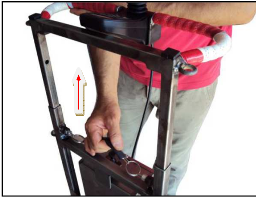
Figura 20 t Fune per la regolazione dell'altezza del timone di comando.
