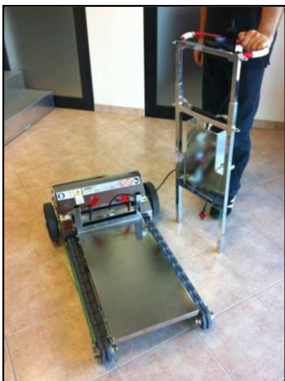
Figura 19 t Carrello saliscale DOMINO in configurazione per il trasporto / Perna di bloccaggio del timone.
