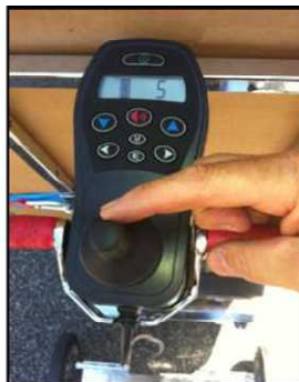
Abbildung 28 - Hochfahren der Treppensackkarre DOMINO auf die Trolley-Basis.
