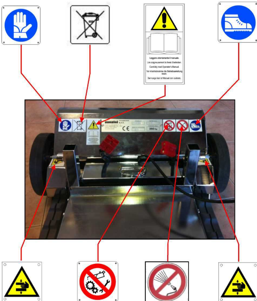
Abbildung 12 - An der Treppensackkarre DOMINO angebrachte Piktogramme.
