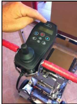
Abbildung 21 - Einschalten der Treppensackkarre
