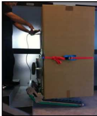
Abbildung 31 - Annäherung der Treppensackkarre DOMINO an die Treppe.
