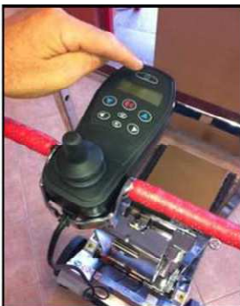
Abbildung 28 - Hochfahren der Treppensackkarre DOMINO auf die Trolley-Basis.
