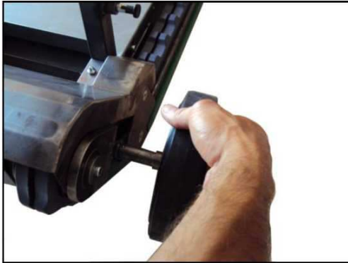
Abbildung 17 - Montage der Räder an der Treppensackkarre DOMINO.
