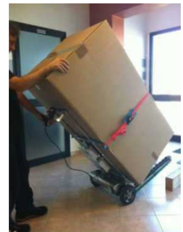
Abbildung 27 - Transport der Ladung auf den Schieberädern.
