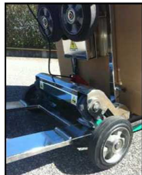
Abbildung 28 - Hochfahren der Treppensackkarre DOMINO auf die Trolley-Basis.
