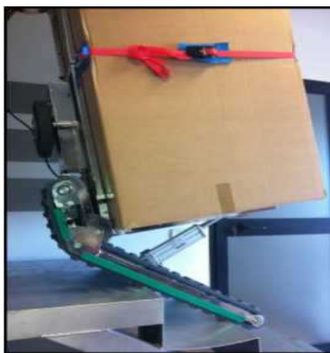
Abbildung 33 - Heranfahren an den Treppenabsatz.
