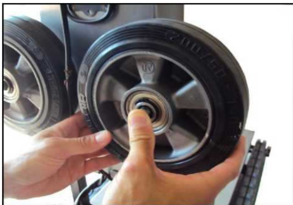
Abbildung 16 - Herausziehen der Räder aus ihrer Halterung.
