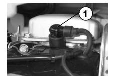
Pulire l'elettrodo (1) della candela di accensione. Misurare la distanza degli elettrodi (1), distanza di 0,6-0,7 mm.
