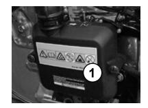
Asportare la cartuccia del filtro dell'aria (1) dall'alloggiamento del filtro dell'aria o dal coperchio del filtro dell'aria.
