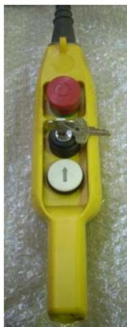
Il TOPLIFT per traslochi viene comandato mediante un pulsante EMERGENZA/SALITA ed un interruttore a chiave DISCESA nel funzionamento ad impulsi.
