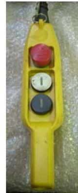
Il TOPLIFT ECO viene comandato mediante il pulsante EMERGENZA/SALITA/DISCESA con funzionamento ad impulsi.
