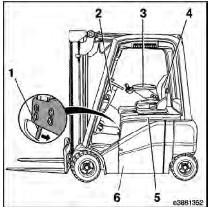
➤ Seitliche Batterietür öffnen, ganz nach rechts schwenken und gegen Zurückschwenken absichern.
