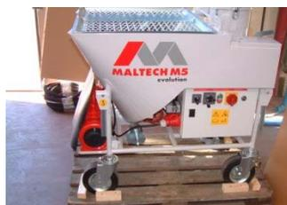
La macchina viene spedita su un pallet con camera e albero di miscelazione smontati. Per la messa in funzione è necessario il montaggio di tali parti.
