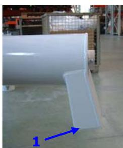
In seguito va controllata la consistenza del materiale all'uscita della camera di miscelazione (1) ed eventualmente va corretta la quantità d'acqua erogata.
