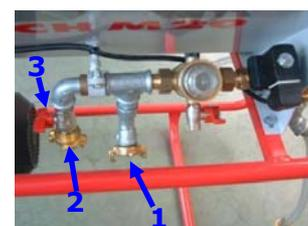
Collegare la manichetta per il trasporto idrico (1) della Macchina ad un rubinetto esterno e scaricare l'aria. Per fare ciò è necessario lasciare aperta la valvola di scarico(3) fino a che non vi siano più bolle sulla manichetta.
