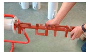
A questo punto si può procedere al montaggio della camera di miscelazione afferrandola per le apposite leve e girando in senso orario fissarla nella propria sede.
