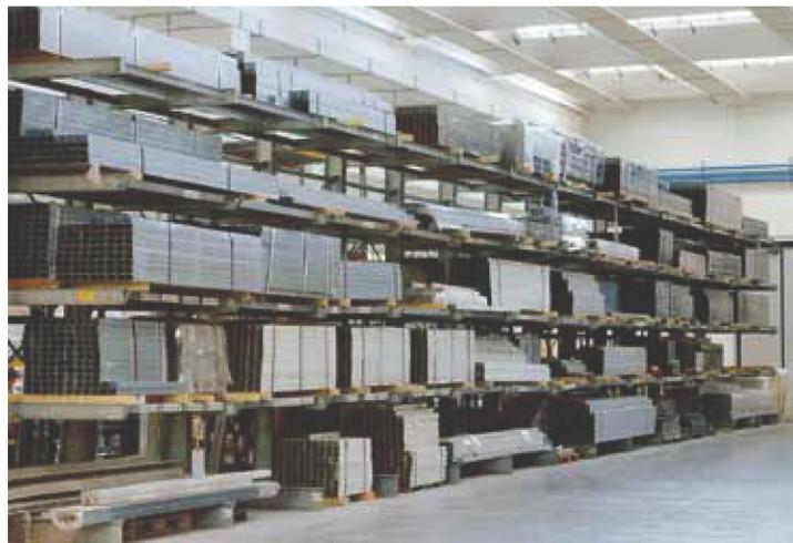
*Magazzino Cantilever piano continuo formati vari*
