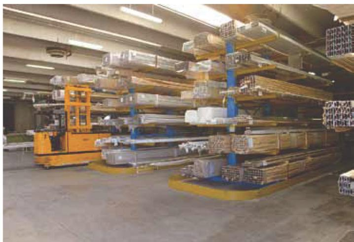
*Magazzino Cantilever P per profili, servito da carrello laterale*
