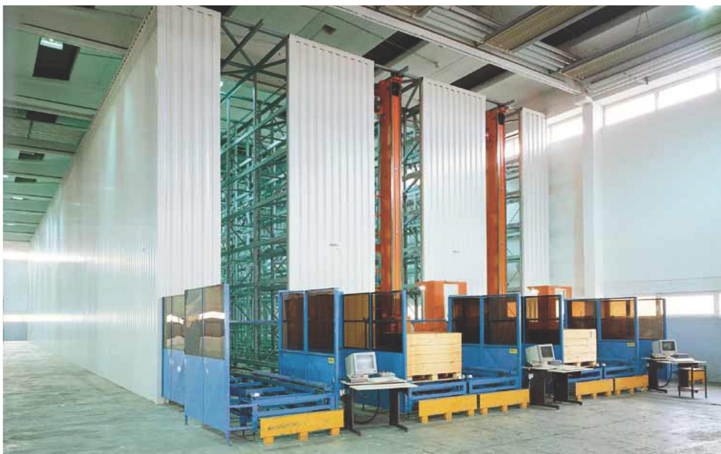
*Deposito Portapallet B90/110 per componenti elettrici, servito da transloelevatori*
